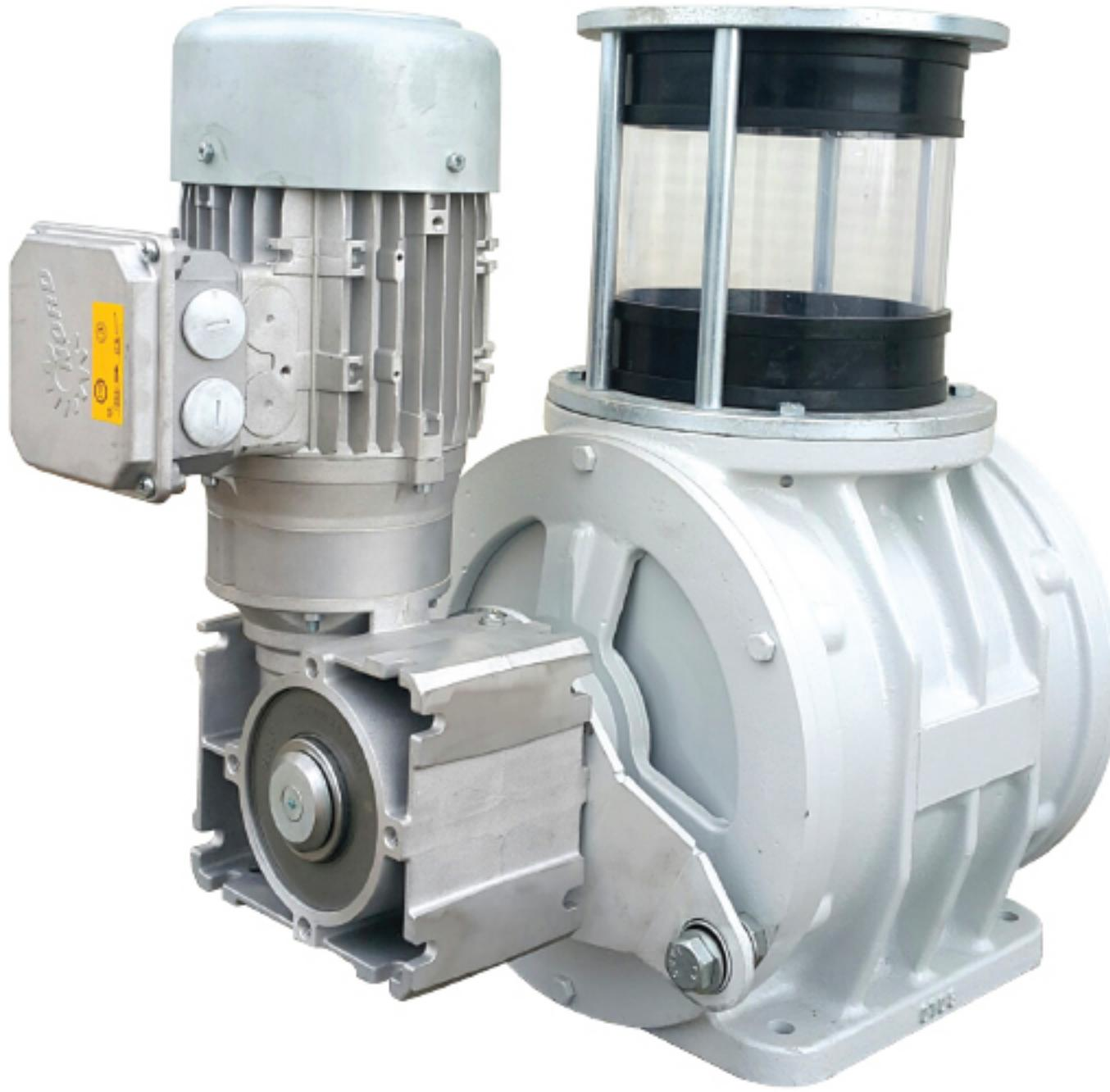
Hava kilidi PSAL, pnömatik değirmen stoklama sistemlerinde, siklonların ve filtrelerin altında nihai ürünlerin boşaltılması için kullanılır. Tekli hava kilidi veya hava kilidi dizisinin bir parçası olarak kullanılabilir. Pozitif veya negatif basınç sistemlerinde kullanılır. Modüler tasarımlı sayesinde kullanılacağı sisteme kolayca entegrasyonu sağlanır. Kurulum için gereken çaba azdır ve bu da kurulum maliyetlerini minimuma indirir.
