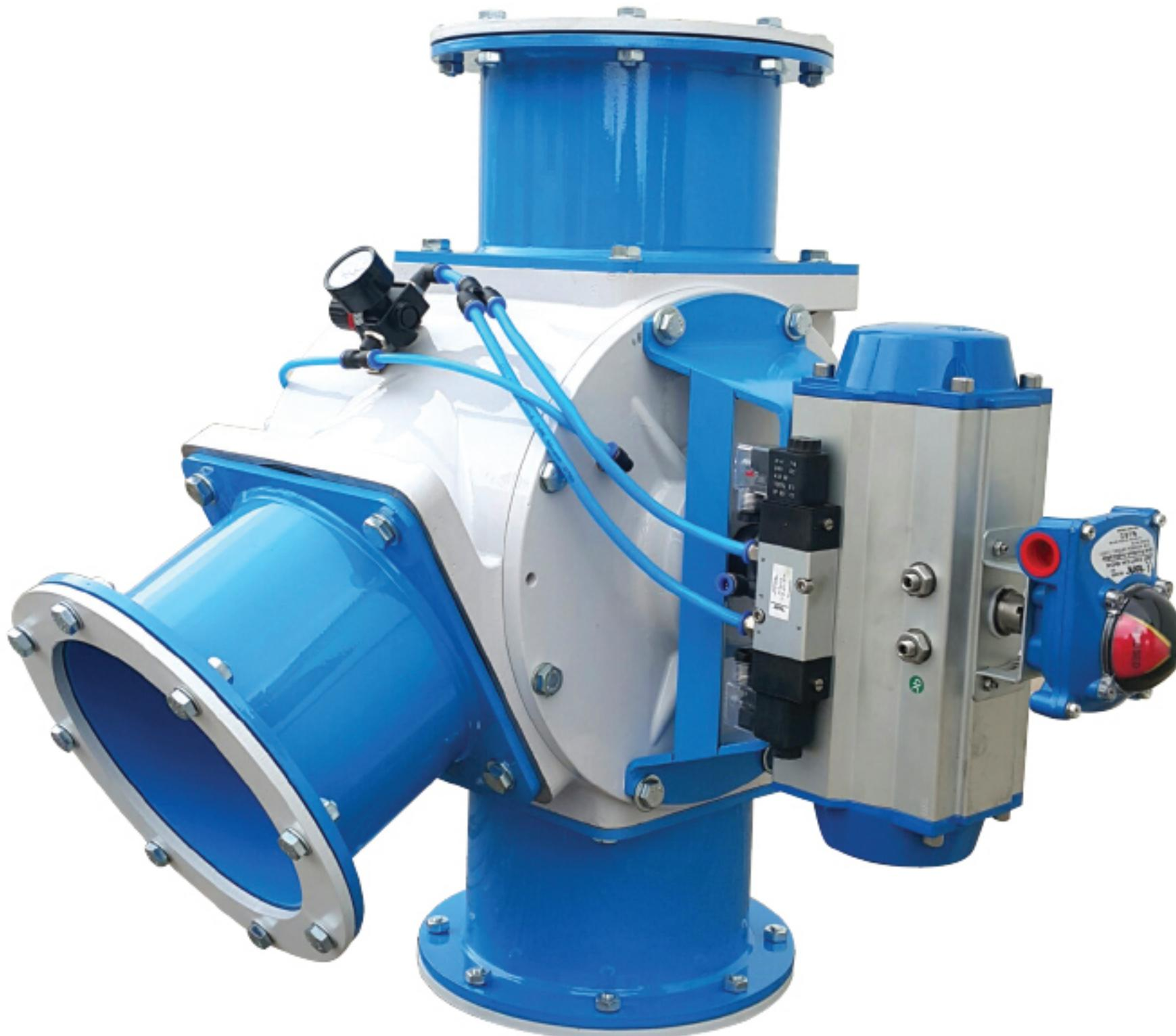
**ÇALIŞMA PRENSİBİ /** Pnömatik taşıma hattında nihai ürünü farklı noktalara aktarma uygulamalarında kullanılan özel olarak tasarlanmış ve üretilmiş vana sistemidir. Alüminyum gövde içerisinde bulunan kelebek klapenin pnömatik aktüatör yardımıyla 60 derecelik bir dönüş yapması sağlanır. Bu sayede nihai ürünün iki farklı yöne transferi sağlanır. Kullanıcıların tüm ihtiyacını karşılamak için model çeşitleri mevcuttur.
