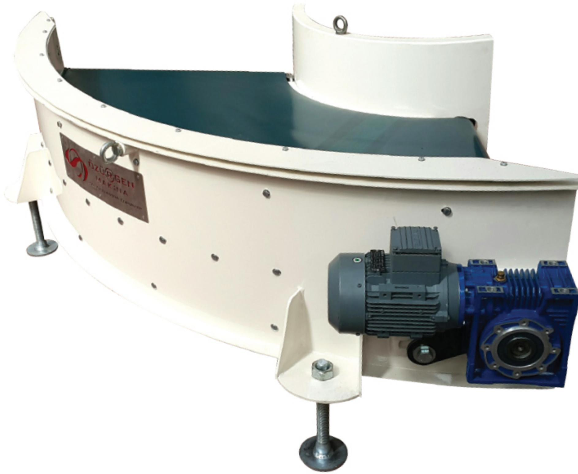
**ÇALIŞMA PRENSİBİ /** Açılı dönüş konveyörleri (Viraj Konveyörleri) paketlenmiş nihai ürünlerin transferi sırasında, aktarma bantları geçişlerinde yön değiştirmesi için kullanılan bir konveyör çeşididir. İstenilen açı aralıklarında, bant genişliği ölçülerinde imalatı yapılabilmektedir. Diğer konveyör hatlarına kolaylıkla entegre edilebilir.
